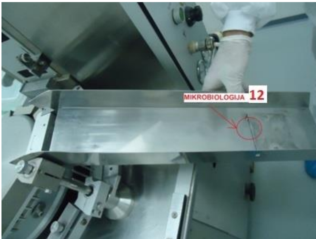
Slika 36 – Kapsulirka – Staza za napunjene kapsule, mesto uzorkovanja MB12
