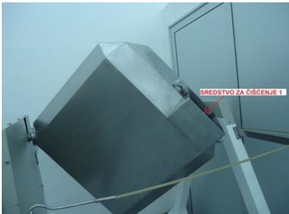
Slika 23- Mešalica tipa kocke – unutrašnjost mesto uzorkovanja HI 1
