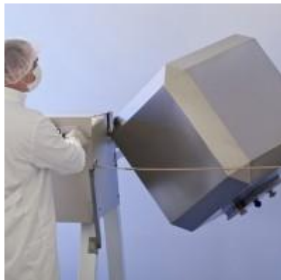
Slika 18: Homogenizator-kocka za mešanje praškastih supstanci
