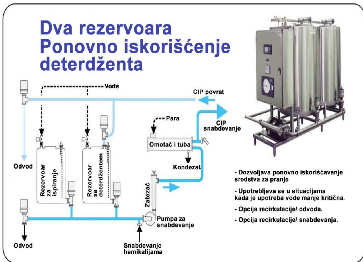
Slika 15: Sistem za automatsko čišćenje sa dva tanka
