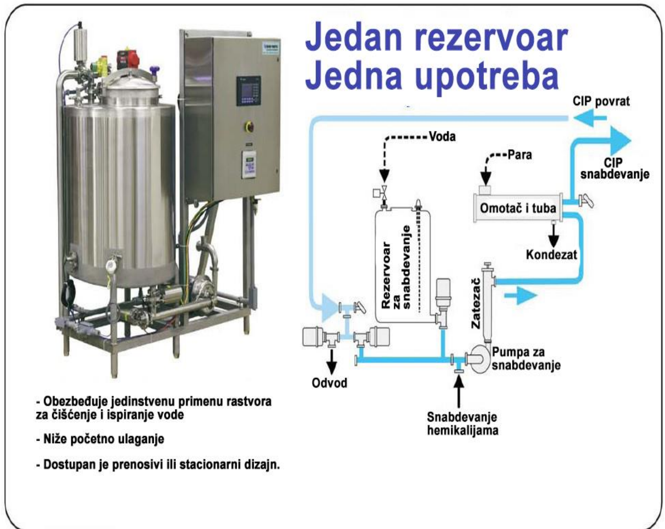
Slika.13: Portabl CIP sistem
