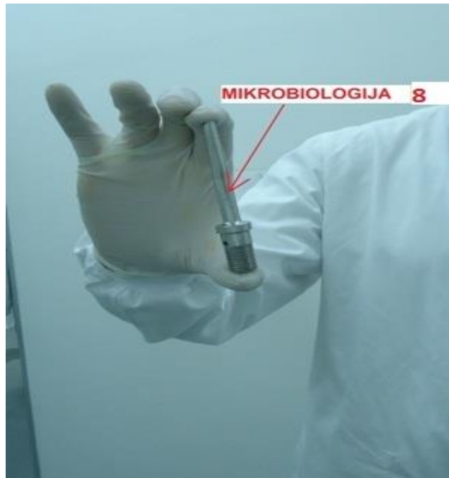
Slika 30 – Kapsulirka – dozirne igle (Doziranje granulata/smeše za kapsuliranje) mesto uzorkovanja MB8
