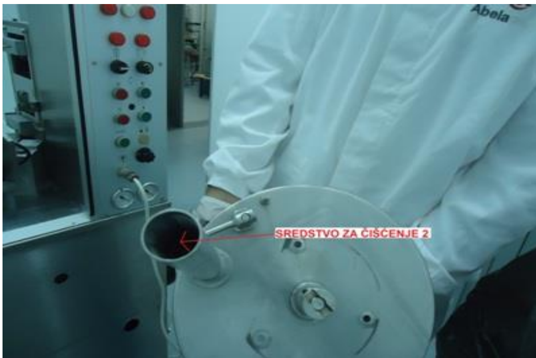
Slika 28 – Kapsulirka – „Koš za masu“ (Doziranje granulata/smeše za kapsuliranje) mesto uzorkovanja HI2
