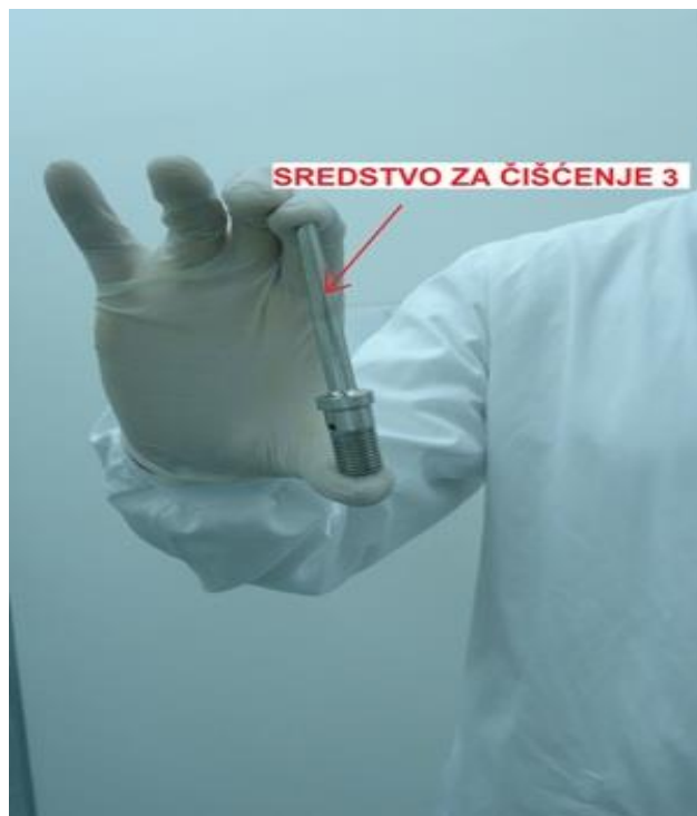
Slika 31 – Kapsulirka – dozirne igle (Doziranje granulata/smeše za kapsuliranje) HI 3
