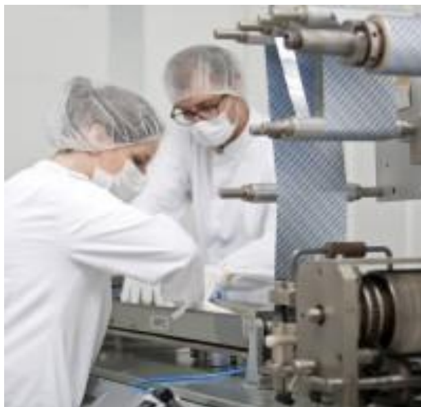
Slika 19: Mašina za blistiranje tipa UHLMANN KP1LA
