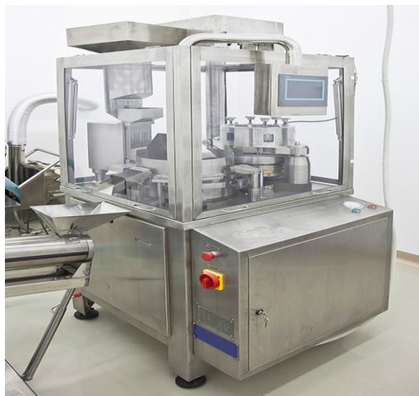
Slika 17: Mašina za kapsuliranje tipa MACOFAR MT 40
