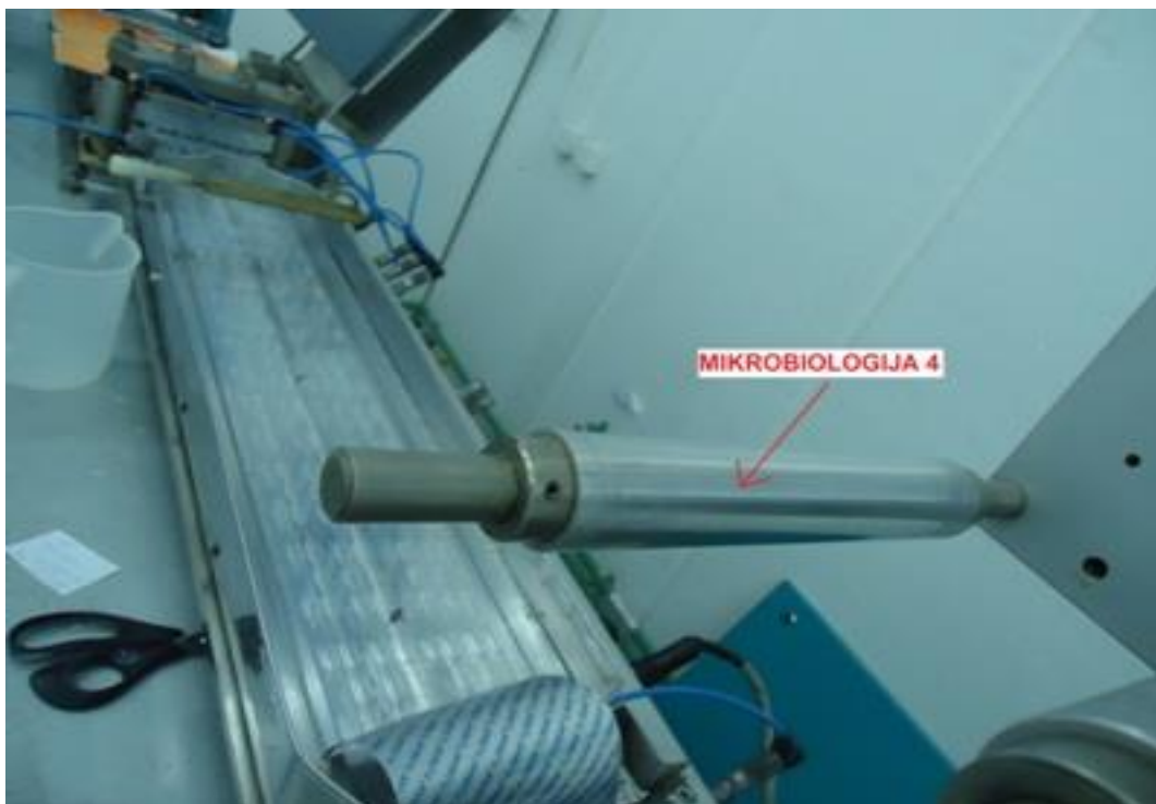
Slika 25 – Blisterica – Namotavanje Al folije mesto uzorkovanja MB4
