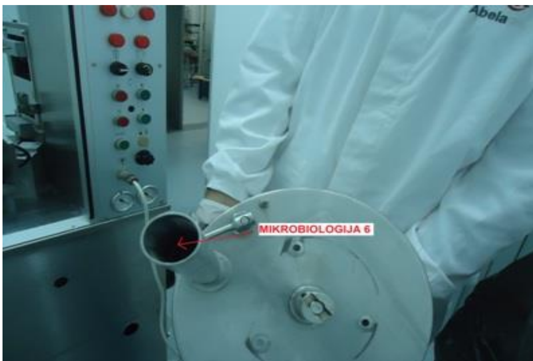
Slika 27 – Kapsulirka – Doziranje granulata/smeše za kapsuliranje mesto uzorkovanja MB6
