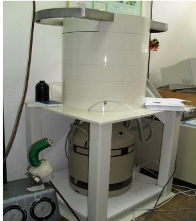
Slika 4. Gama spektrometar ORTEC GEM 50 sistem, Javno Preduzeće „Nuclear Facilities of Serbia”
