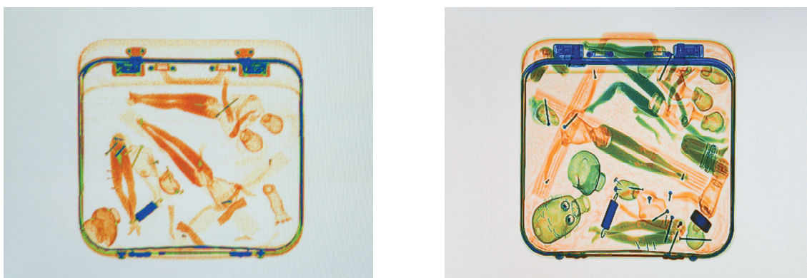
Slika 18. Rendgenski snimci dobijeni korišćenjem slabijeg uređaja Smits Hajman 5030 (levo) i naprednijeg uređaja Smits Hajman 6040 (desno)
