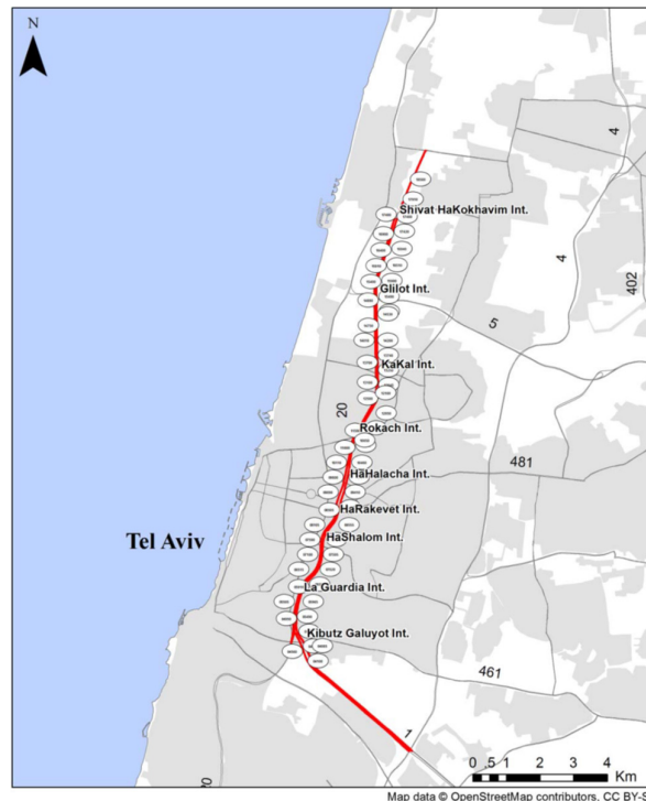
Slika 5.1 Raspored detektora i definisanje segmenata autoputa (Bekhor i dr., 2013)
