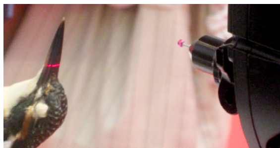
Слика 31. Приказ поступка мерења методом 3D ласерског скенирања
