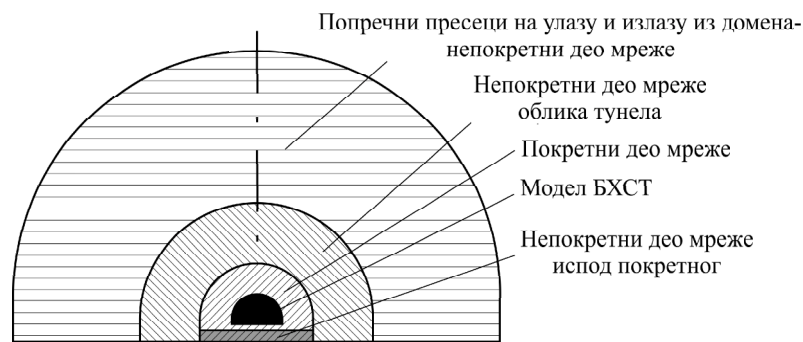
Слика 85 Шема распореда мрежних елемената
