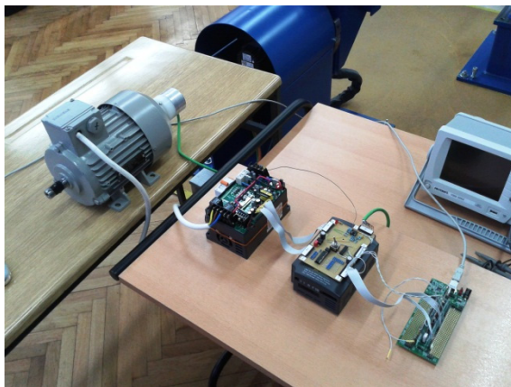
Слика 41. Функционално повезани мотор, енергетски претварач, интерфејс и ДСП у почетној фази истраживања.
