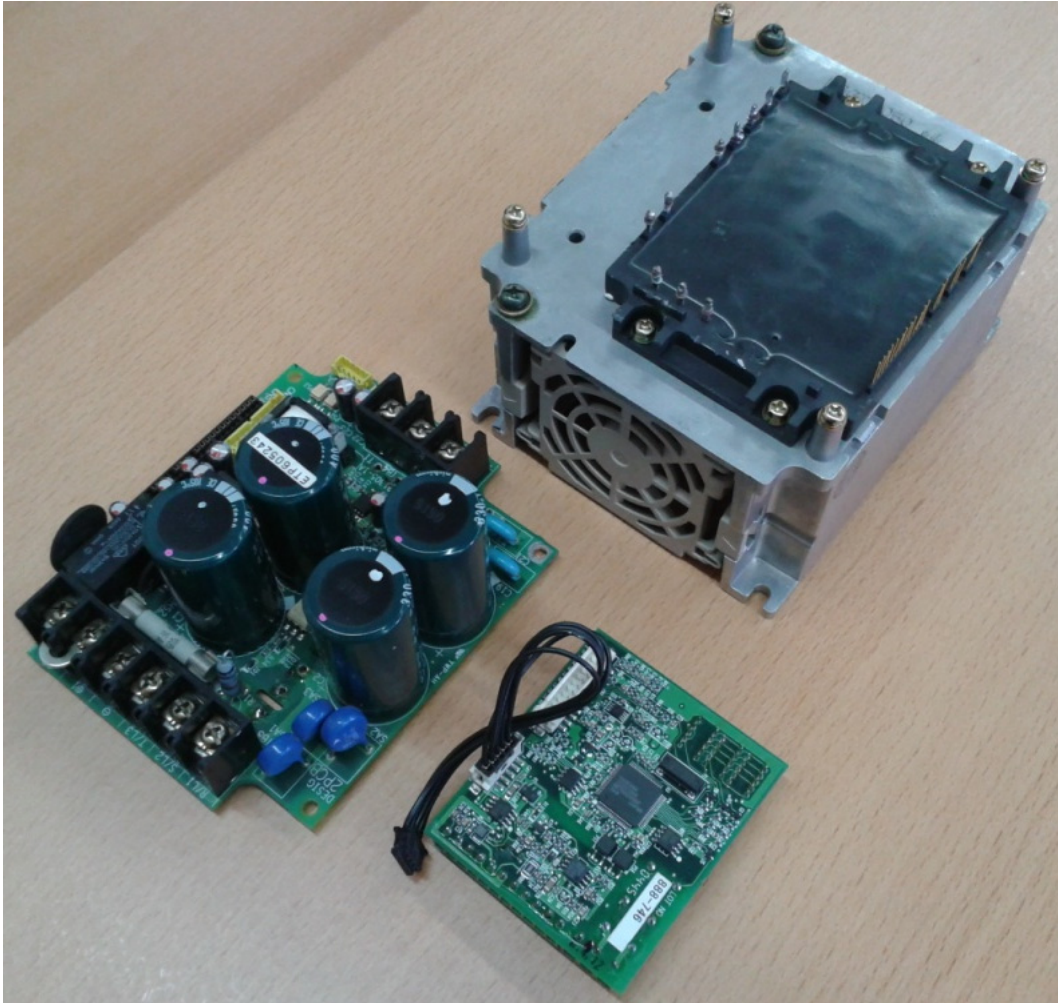
Слика 31. Фреквенцијски регулатор Yaskawa , CIMR-J7AZ42P2 .
