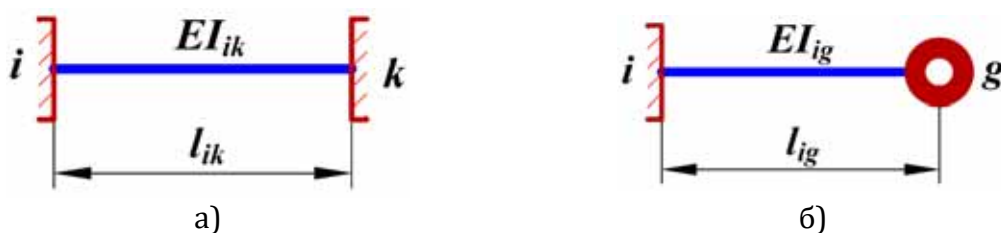
Слика 3.14 Типови коначних елемената а) коначни елемент типа ik , б) коначни елемент типа ig
