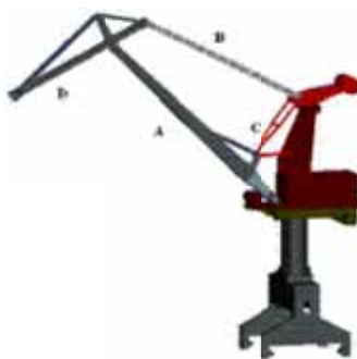
Слика 1.12 Коначно-елементни модел портално-обртне дизалице [24]
