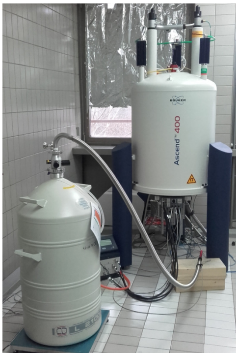
Slika 23. NMR spektrometar Bruker AVANCE III HD 400 MHz - Prodigy
