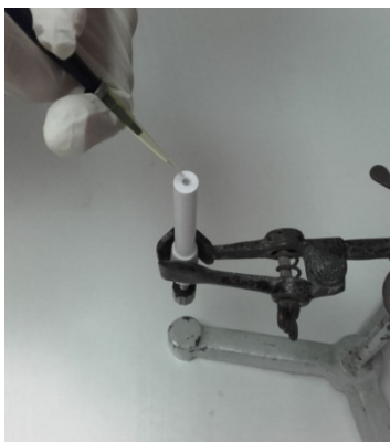
Slika 25. Postupak površinske modifikacije CPE sa suspenzijom koloidnog zlata metodom nanošenja kapi
