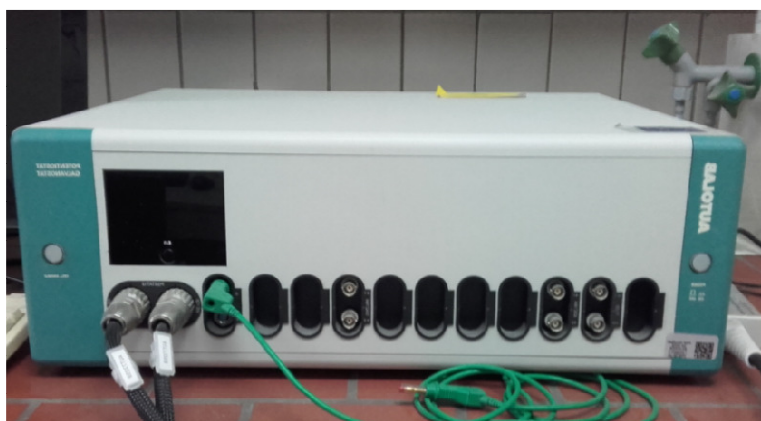
Slika 18. Voltametrijski uređaj, potenciostat i galvanostat, AUTOLAB PGSTAT 12
