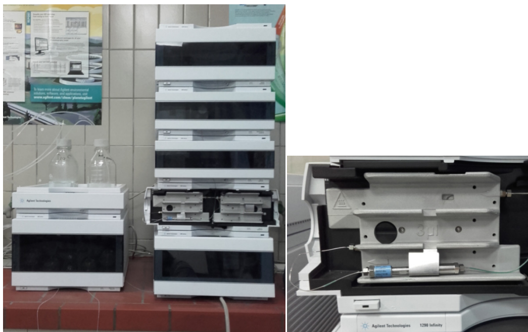
Slika 22. Tečni hromatograf Agilent 1290 Infinity i Zorbax Eclipse Plus C18 kolona
