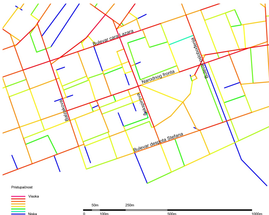
Grafikon 13 Analiza pristupačnosti putanja za fragment Limana 3 (through-movement potential) određena na osnovu normalised choice measurement za kombinaciju lokalnog radijusa (400 m) i globalnog (gradski nivo) (autorski prilog).
