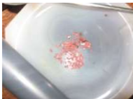
Слика 15. \epsilon\text{-Fe}_2\text{O}_3/\text{SiO}_2 прах након одгревања на 1050 °C 4h.
