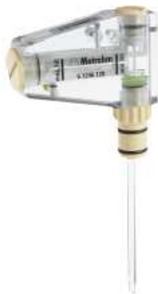
Slika 3. Višenamenska elektroda koja može funkcionisati kao HMDE, DME ili SME (Metrohm)
