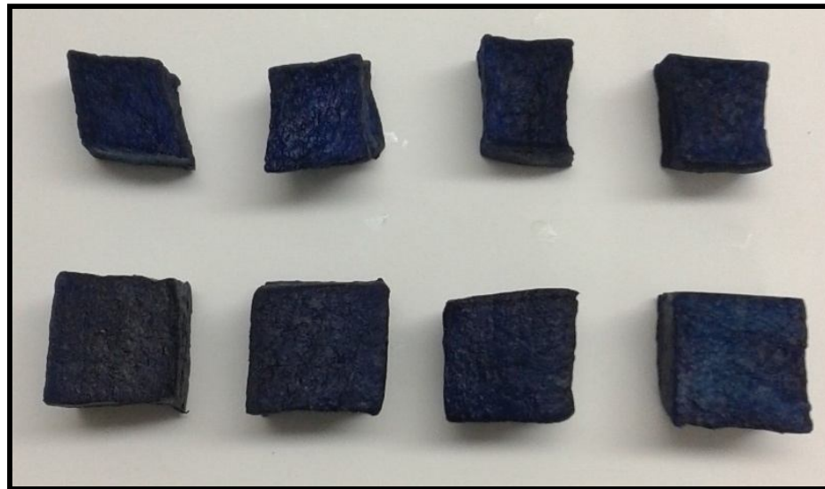
Slika 5.11. Promena zapremine uzorka dunje nakon osmotskog sušenja. Gornji red – uzorci bez prethodnog zamrzavanja, donji red – prethodno zamrzavani uzorci (foto Radojčin, 2014)
