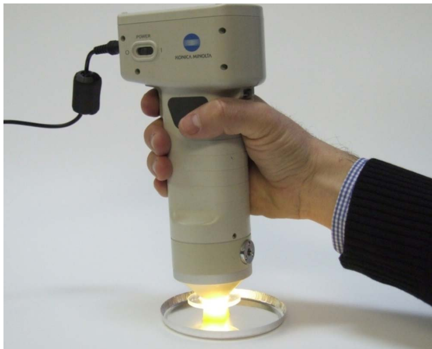
Slika 4.15. Merenje boje kolorimetrom Konica Minolta CR 400
