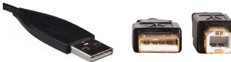
slika 4.18 – USB Type A utikač (levo), utičnica (sredina), Type B utičnica (desno)
