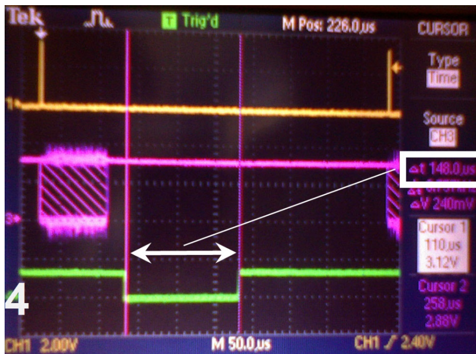
slika 4.60 – transfer Ethernet okvira – 148\mu s
