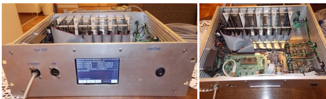
slika 5.3 – instrument za merenje deformacija armature temelja
