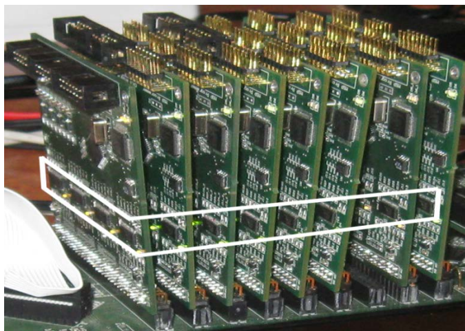
slika 4.2 – DSP blok (zaokruženi su TAS procesori)
