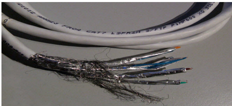
slika 4.15 – Cat 7 STP kabel - oklopljeni kabel sa četiri oklopljene upredene parice
