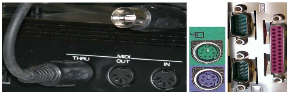
slika 4.10 – MIDI (levo), PS/2 (sredina), serijski i paralelni portovi (desno)
