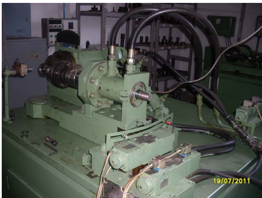
Slika 8.6. Sto za dinamičko ispitivanje ležaja, delovanjem aksijalne i radijalne sile
