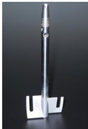
Slika 11. Propelerski rotor FL2B
