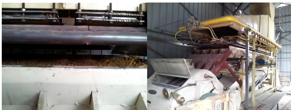
Slika 8. Uređaj za mikronizaciju zrna kukuruza
