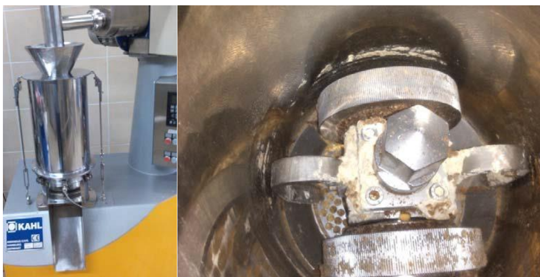
Slika 6. Pelet presa sa ravnom matricom
