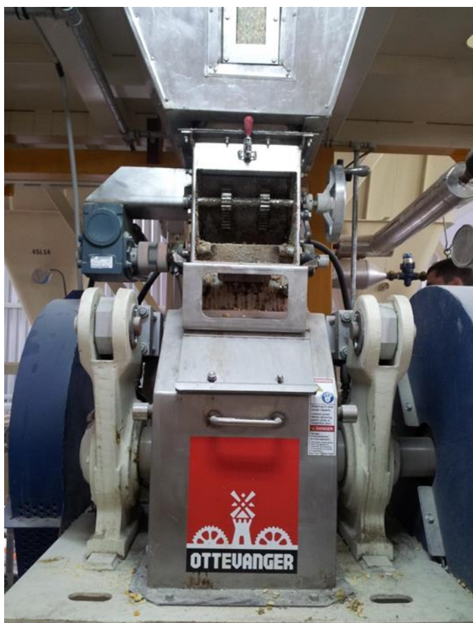
Slika 7. Uređaj za parno flekičanje zrna kukuruza
