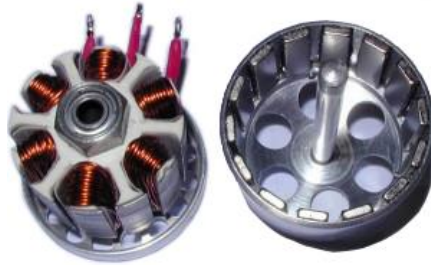
Slika 4. Prikaz BLDC motora sa šest statorskih namotaja i 14 rotorskih polova [17].
