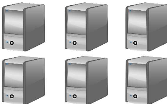
Slika 3.1: Shematski prikaz matrice računara (klaster) za P=2, Q=3 .
