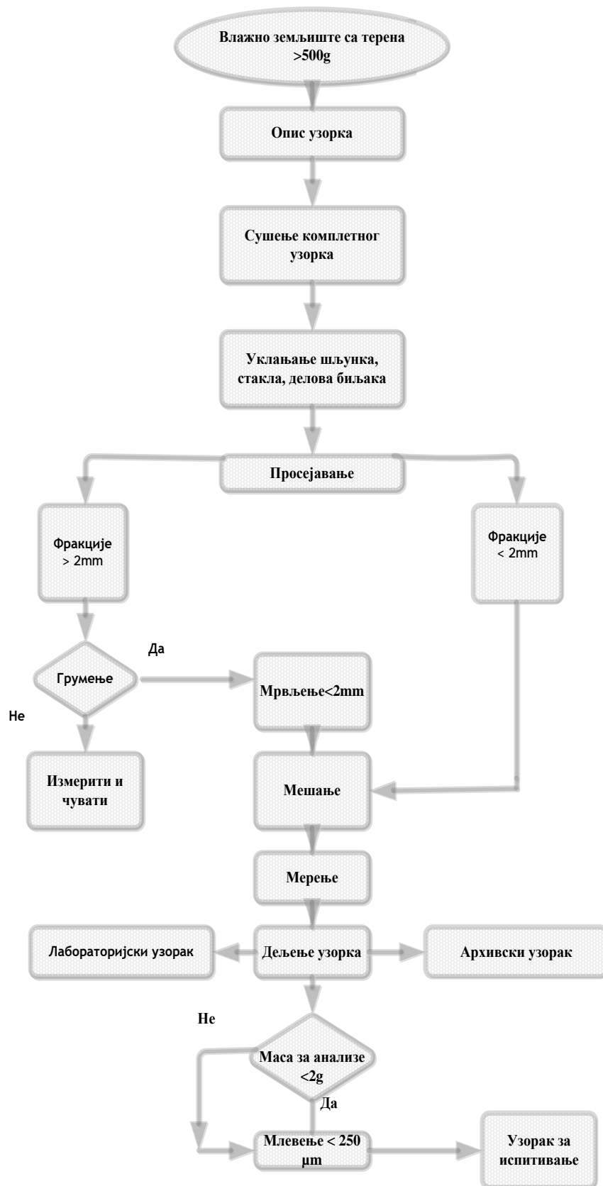
Слика 5.4.2 Дијаграм претходне обраде узорка земљишта
