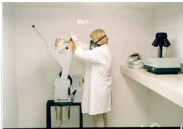
Слика 5.4.3 Млевење узорака на млину за млевење: Model: Cutting Mill SM 200, Retsch, Градски завод за јавно здравље Београд
