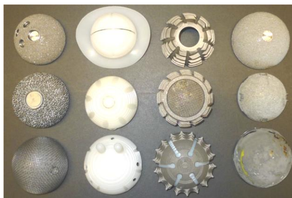
Slika 49. Prikaz poledine novih i izvađenih acetabularnih komponenti (s leva na desno po kolonama: bescementne čašice, cementne čašice, sa navojem, monolitne čašice)
