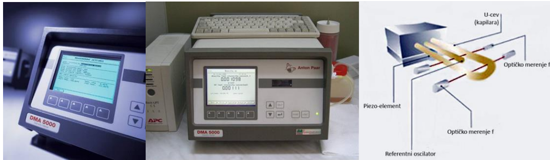
Slika 3.10 Gustinomer Anton Paar DMA 5000 i šematski prikaz merne ćelije gustinomera [67].
