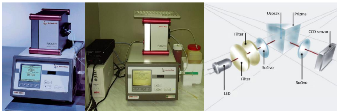
Slika 3.11 Kombinovani sistem gustinomer Anton Paar DMA 5000 i refraktometar RXA 156 i šematski prikaz merne ćelije refraktometra [67].
