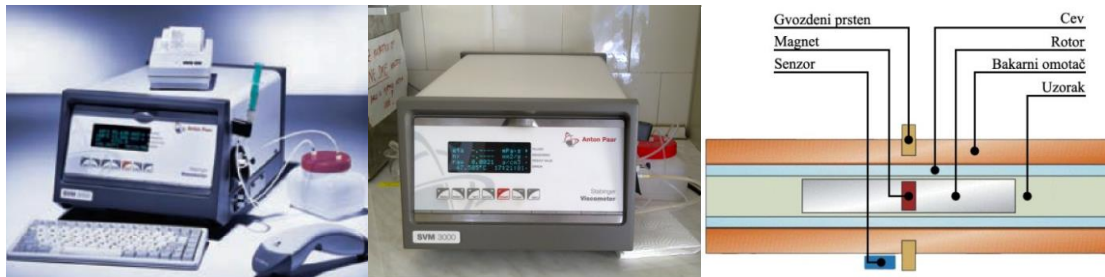
Slika 3.9 Viskozimetar Anton Paar SVM 3000 i šematski prikaz merne ćelije viskozimetra.
