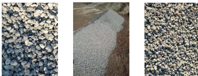
Слика 4.6 Рециклирани агрегат добијен дробљењем старог бетона
