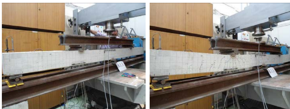
Слика 4.47 Диспозиција испитиваног гредног носача пре оптерећења и под оптерећењем
