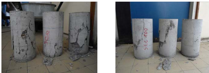
Слика 4.20 Цилиндрични узорци после испитивања
