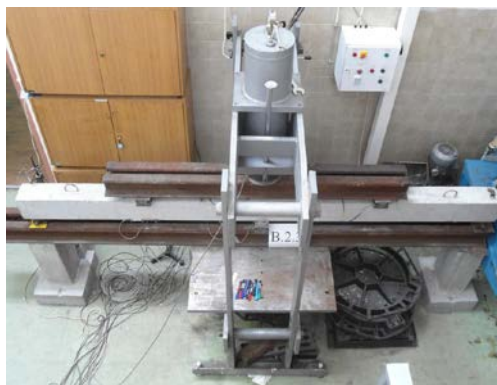
Слика 4.26 Дислокација континуалног носача у фази испитивања
