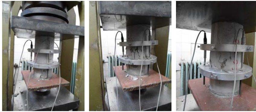
Слика 4.16 Диспозиција оптерћених епрувета и приказ мерних линија за одређивање модула еластичности
