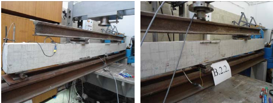
Слика 4.60 Диспозиција гредног носача пре оптерећења и током наношења оптерећења
