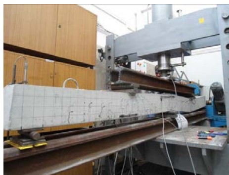
Слика 4.85 Диспозиција испитиваног гредног носача под оптерећењем
