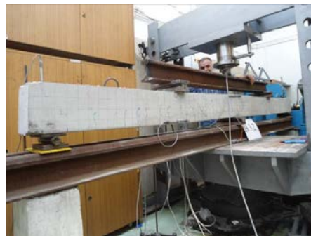
Слика 4.78 Диспозиција испитиваног гредног носача у фази наношења оптерећења
