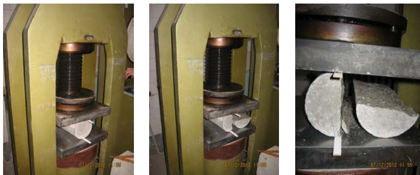
Слика 4.23 Одређивање чврстоће при затезању цепањем
