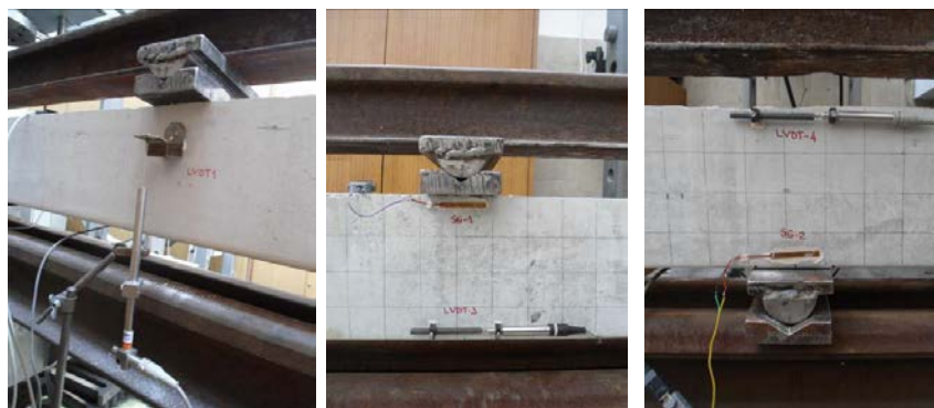
Слика 4.27 Положај угибомера, дилатомера и мерних трака на бетону у фази испитивања
