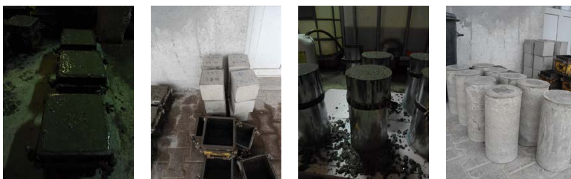
Слика 4.10 Бетонирање пробних тела и њихов изглед
