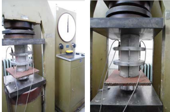
Слика 4.14 Диспозиција узорака под оптерећењем и приказ мерних линија за одређивање везе напон–дилатација
