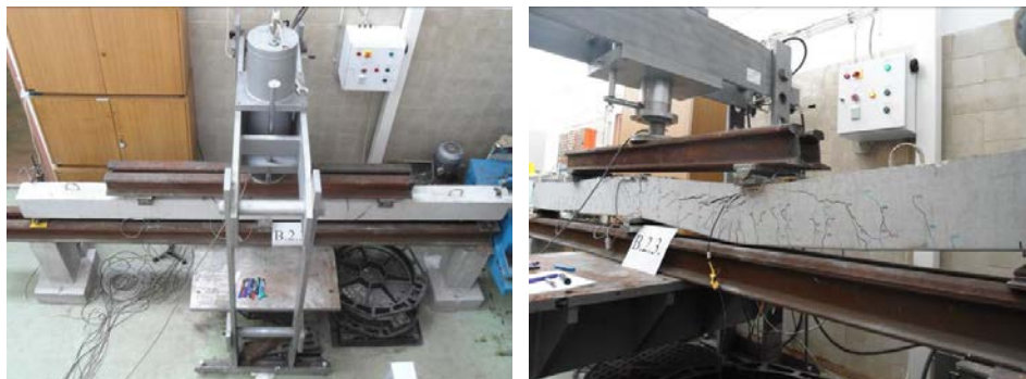
Слика 4.66 Диспозиција гредног носача пре оптерећења и током доношења оптерећењем
