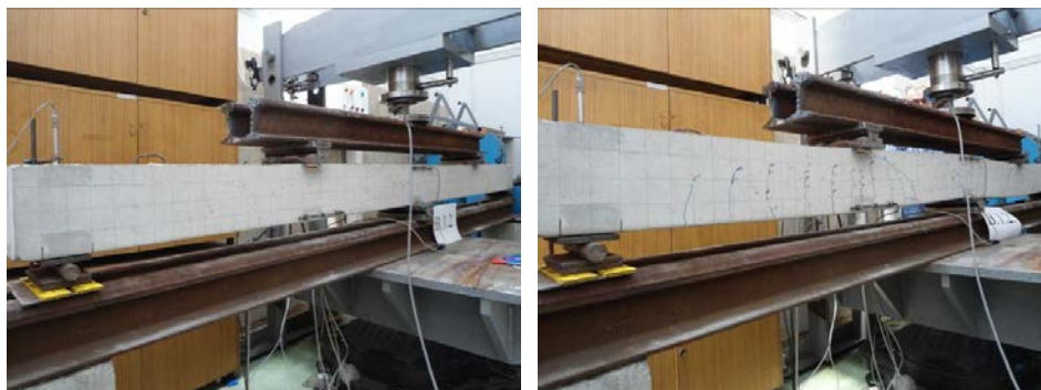
Слика 4.40 Диспозиција испитиваног гредног носача пре оптерећења и под оптерећењем
