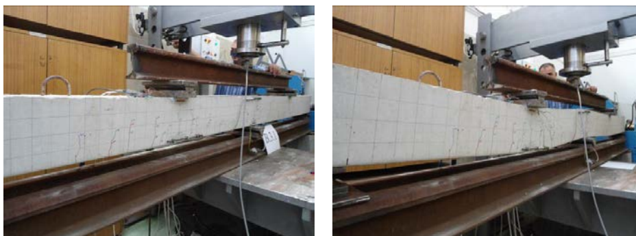
Слика 4.73 Диспозиција испитиваног гредног носача током доношења пробног оптерећења
