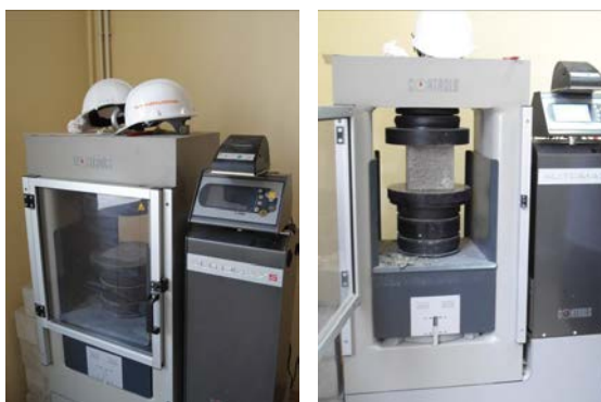
Слика 4.12 Преса Controls-model Automax 5
