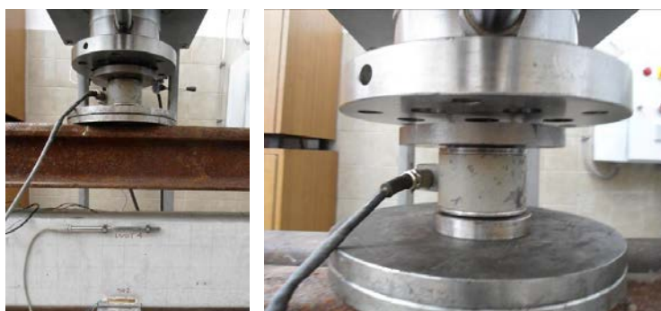
Слика 4.29 Мерење интензитета силе електронским динамометром
