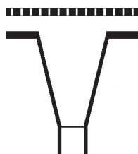
Slika 6. Konus za izvod sladovine (Briggs i sar., 2004)
