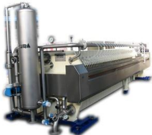
Slika 11. Filter za kominu 2001 (proizvođač Meura, Belgija)
