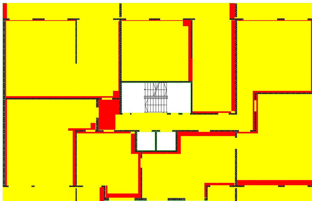
Slika 40. – Upotreba različitih sistema oplate ploče za Objekat 17
