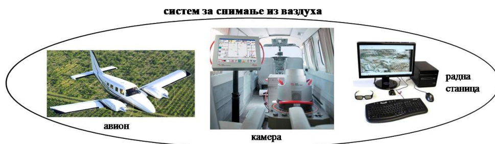
Слика 15. Технолошка линија за АФС ВГИ
