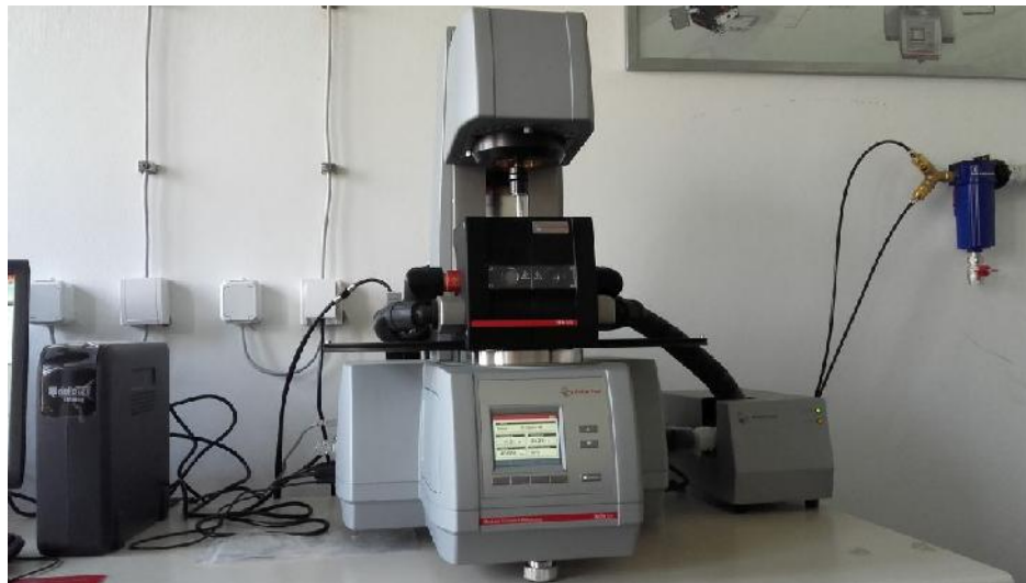
Slika 3.10. Modularni kompaktni reometar MCR-302 opremljen sa komorom za regulisanje temperature
