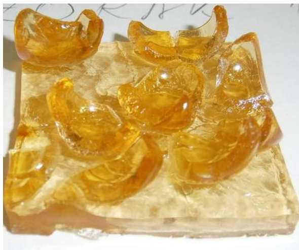
Slika 4.4. Izgled uzorka veziva nakon 48 časova u toluenu
