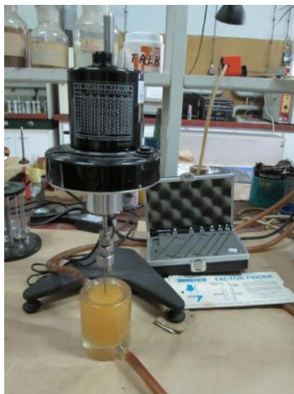
Slika 3.4. Rotacioni Brookfield viskozimetar sa Grifinovom čašom za merenje prividnog viskoziteta neumreženog KRG
