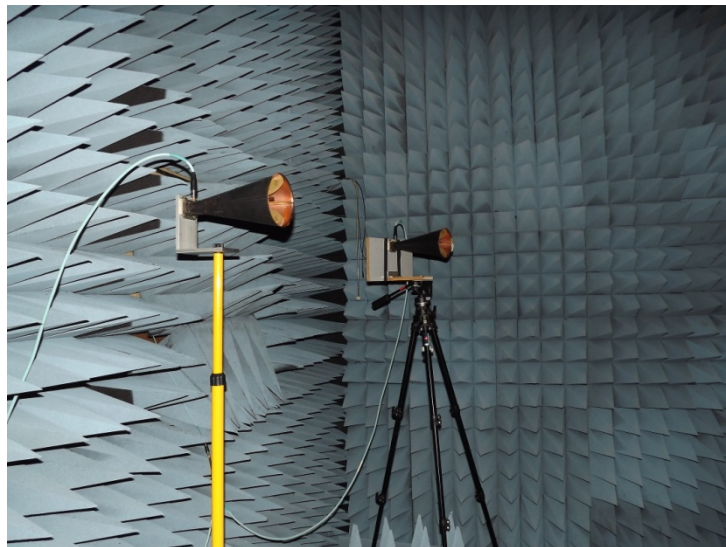
Slika 8.10 Dve predajne levak antene u anehoičnoj komori
