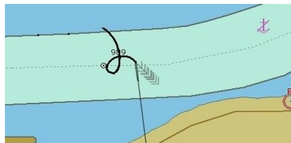
Слика 7.8. Маневар окрета у режиму спрега десни ЕМ крмом 1000 \text{ min}^{-1} , леви ЕМ напред 1000 \text{ min}^{-1} и кормило десно сасвим
