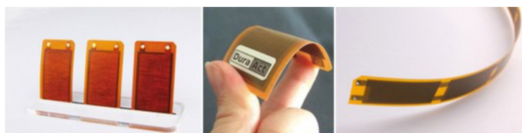
slika 5.8. Piezoelektrični aktuatori, male debljine, koji realizuju savijanje [249]
