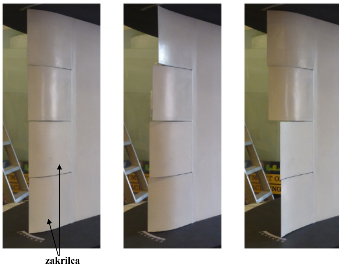
slika 2.3. Lopatica vetrenjače koja menja oblik svog profila zakretanjem zakrilca [6]
