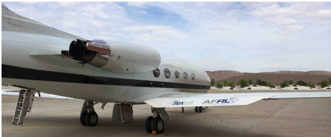
slika 2.30. Avionsko krilo koje može da menja svoj oblik (a) implementirano na letelici Gulfstream III business jet (b) [35]
