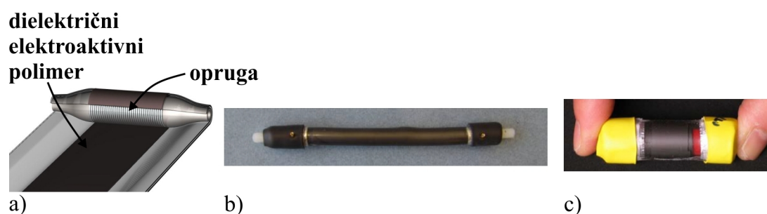
slika 5.5. Dielektrični elektroaktivni polimer aktuatori koji realizuju aksijalani radni hod na istežanje: a) izrada aktuatora [242]; b) DEAP aktuator prečnika 10 mm i dužine 150 mm, koji može da realizuje pogonske sile od 11 N i radni hod od 25 mm [242]; c) DEAP aktuator prečnika 12 mm i dužine 40.5 mm, koji može da realizuje pogonske sile od 5.5 N i radni hod od 2.7 mm [243]
