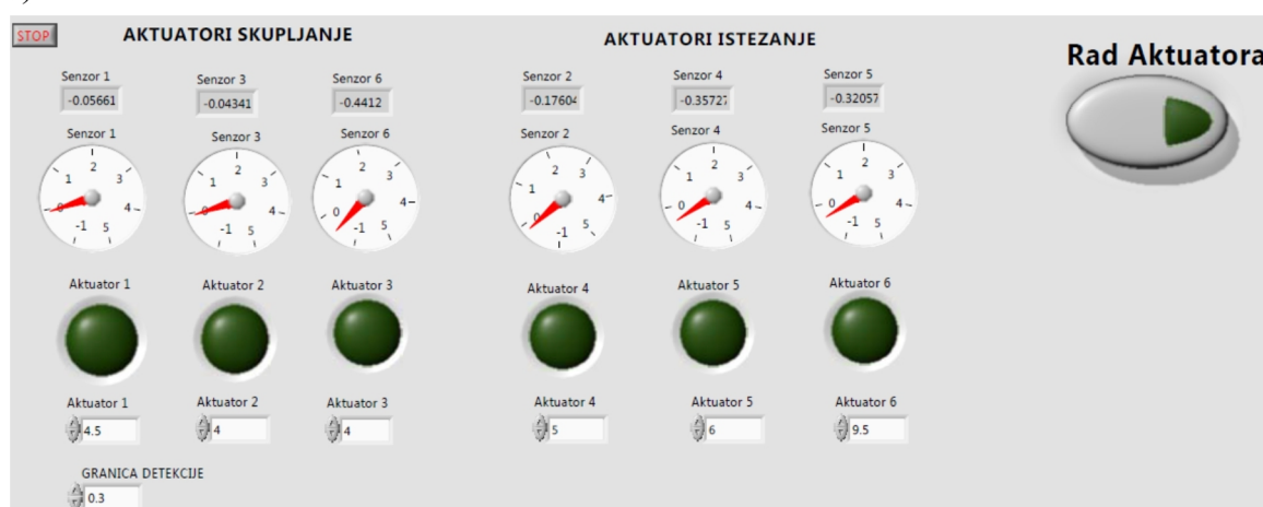
slika 7.1. a) Algoritam upravljanja adaptivnom gipkom strukturom sa aktuatorima od nitinol žice i senzorima od provodne pene, razvijen u programskom paketu LabView ; b) odgovarajuća virtualna instrumentacija
