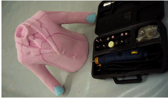
41. Пример одела , израђено на ЦНЦ машини и дорађено брусилицом, турпијом и бијаксом
