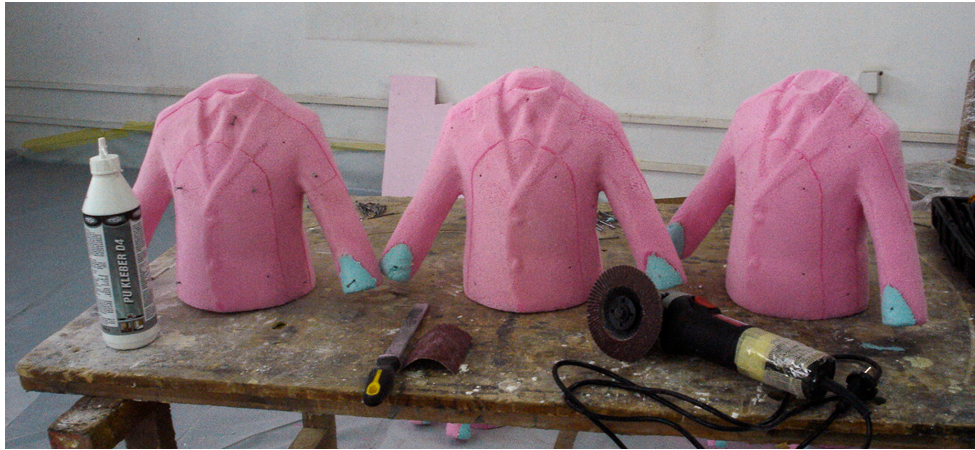
30. Процес реализације , обрада површине форми одела, лепљење, брушење, шмирглање стиродура
