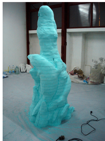
34. 35. Процес реализације , формирање сегмената централног стуба и њихова дорада, скидање вишка материјала брусилцом
