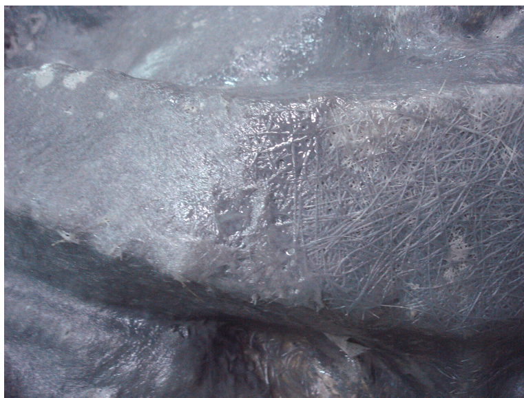
33. Процес реализације , површина ламинирана полиестер смолама и стакленом матом са леве стране слике види се додат последњи слој Ц стакла
