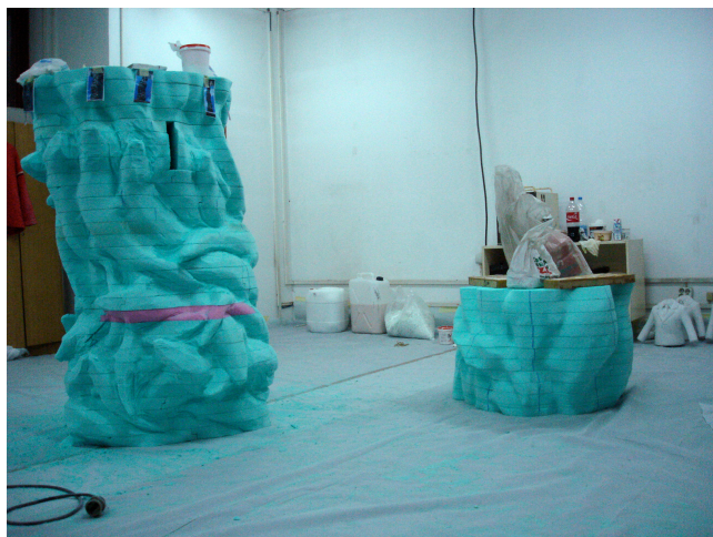
34. 35. Процес реализације , формирање сегмената централног стуба и њихова дорада, скидање вишка материјала брусилцом
