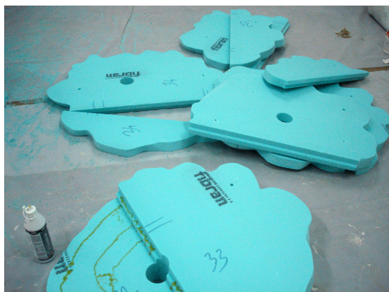
28. Процес реализације, лепљење и слагање слојева стиродура
