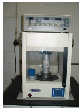
Slika 72. Tipovi presa za presovanje uzoraka: a) Ručna presa, b) Hidraulična presa
