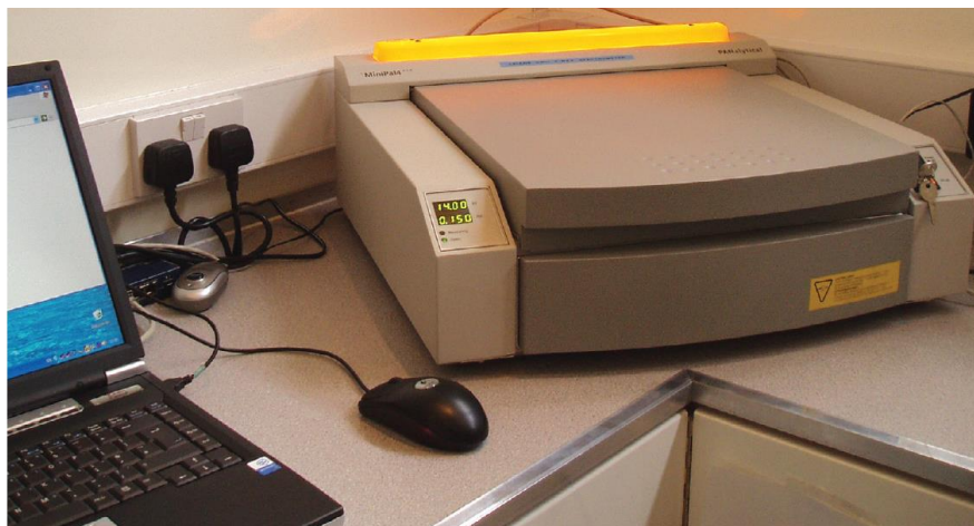
Slika 75. ED-XRF instrument MiniPal 4 na kome su izvršene analize sedimenta
