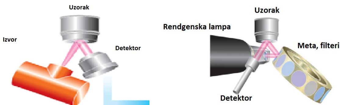
Slika 57. ED-XRF sa 2D optikom i direktnom ekscitacijom (levo) i polarizovanom optikom (3D) sa indirektnom ekscitacijom (desno)[33]
