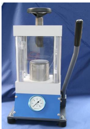
Slika 72. Tipovi presa za presovanje uzoraka: a) Ručna presa, b) Hidraulična presa
