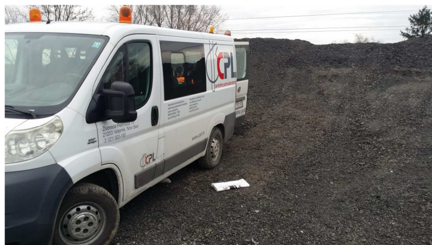
Slika 56 Deponija RAP-a na asfaltnoj bazi Srbobran, BAČKA PUT AD, Novi Sad.
