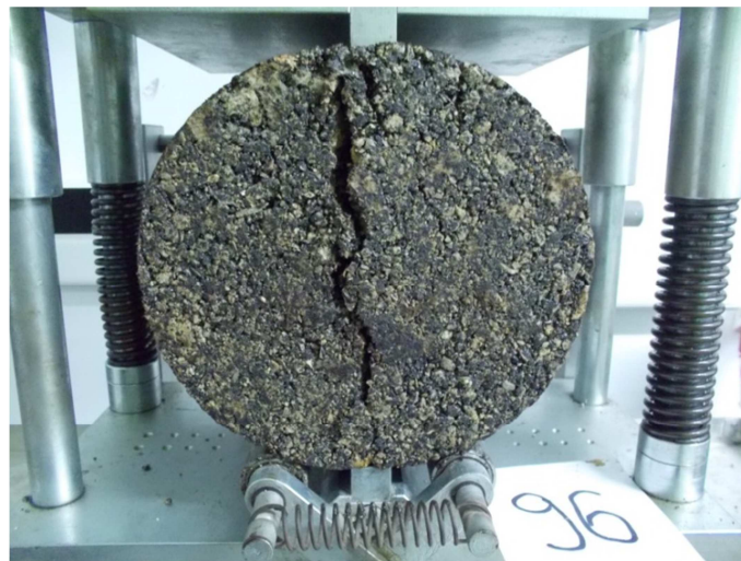
Slika 64 Uzorak nakon loma odnosno nakon završenog ispitivanja indirektna zatezne čvrstoće u presi.
