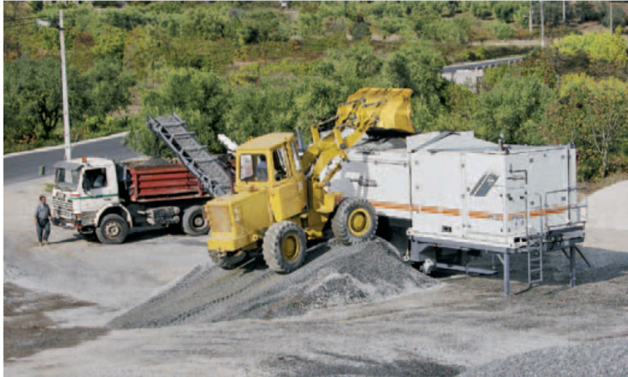
Slika 14 Voz za hladnu reciklažu na licu mesta postavljen kao centralno postrojenje za hladno recikliranje. [17]
