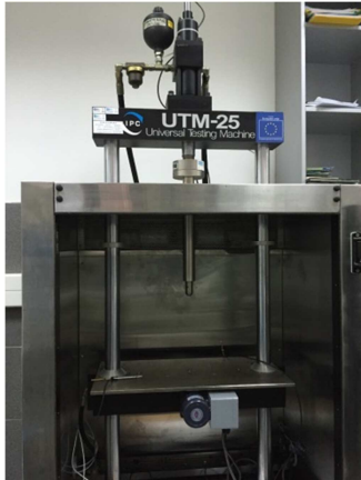
Slika 92 Oprema za ispitivanje zamora i modula ITSFT i ITSM na Građevinskom fakultetu u Beogradu.
