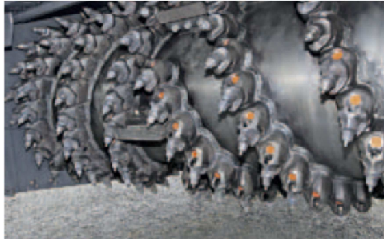
Slika 5 Izgled standardnog bubnja za frezovanje na mašinama za hladno recikliranje na licu mesta. [17]
