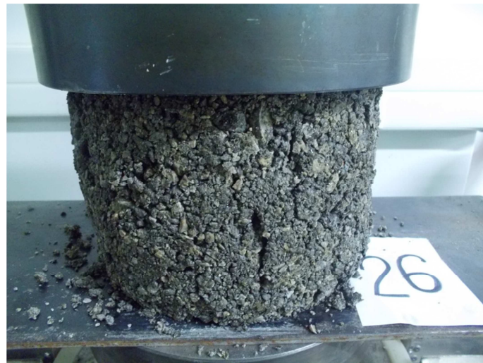
Slika 62 Uzorak nakon loma odnosno nakon završenog ispitivanja pritisne čvrstoće u presi.
