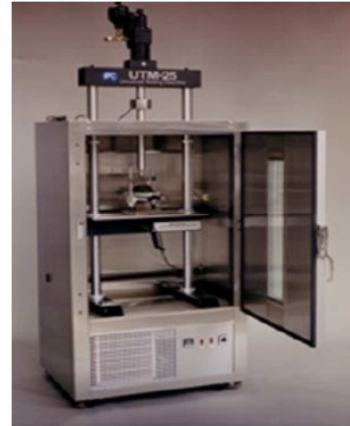
Slika 92 Oprema za ispitivanje zamora i modula ITSFT i ITSM na Građevinskom fakultetu u Beogradu.
