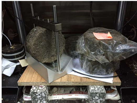
Slika 94 Postupak kondicioniranja uzoraka u klima komori uređaja na temperaturu izvođenja opita.
