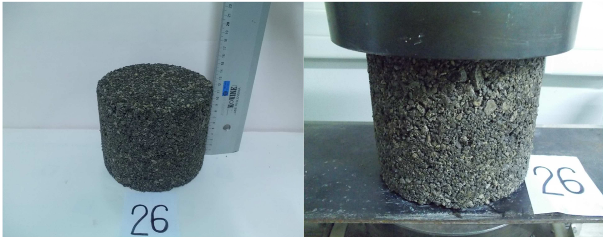
Slika 61 Pripremljeni uzorak za ispitivanje pritisne čvrstoće pre izvođenja ispitivanja, na merenju dimenzija i u presi.
