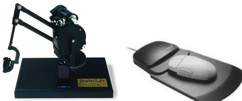
Слика 3.9 PHANToM и FEELit Mouse (Sjöström and Rasmus-Gröhn, 1999)
