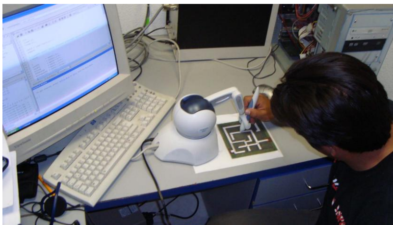
Слика 3.10 PHANToM OMNI pencil - experimental validation of the kinematics (Jarillo-Silva et al., 2009)
