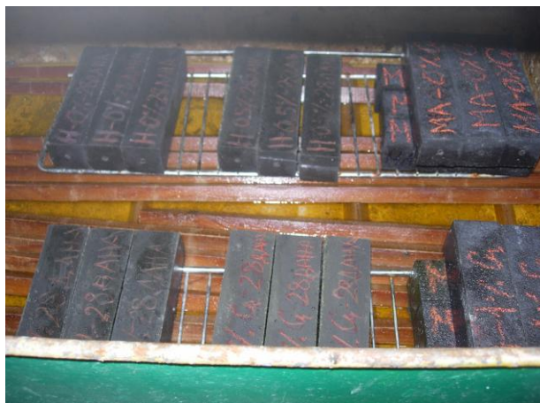
Слика 6.31. Изглед геополимера (малтера) на бази ЕФП и МЕФП Колубара у влажном простору
