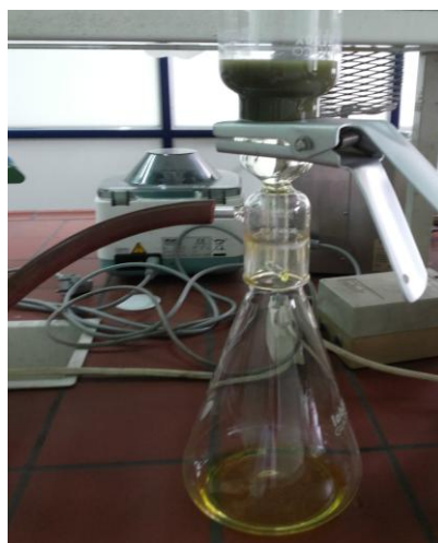
Слика 6.13. Филтрација геополимера и добијање процедурне течности
