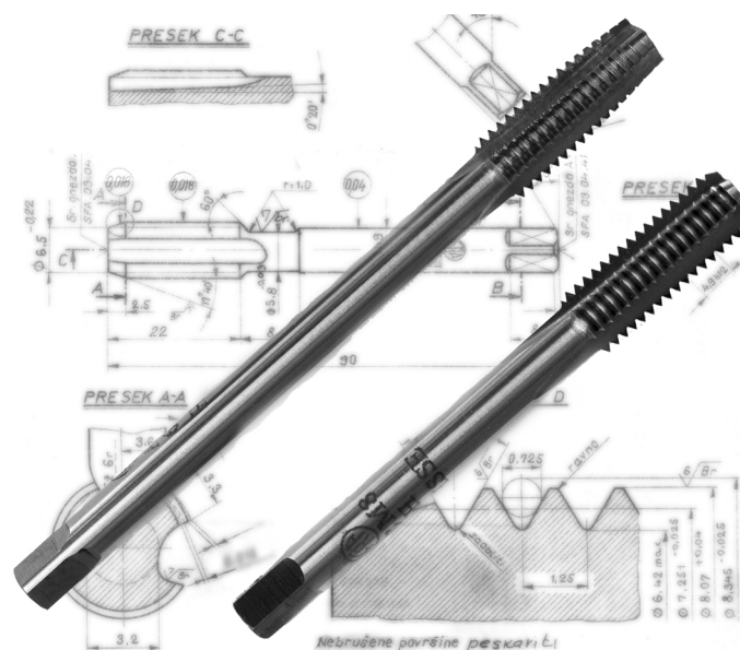
Слика 7.3. Урезници коришћени у експериментима ( \check{C}9780 ), ФРА Чачак
