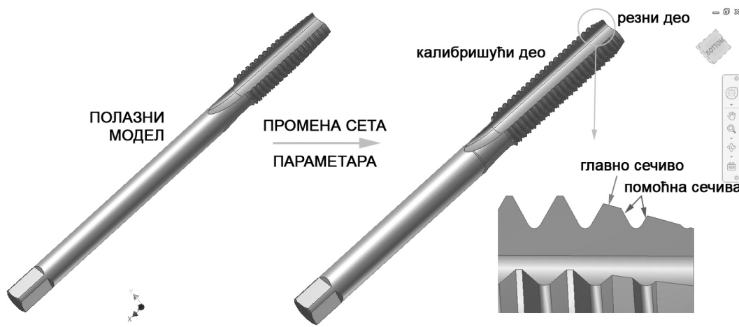
Слика 6.5. Параметарски дефинисан модел машинског урезника са правим жлебовима
