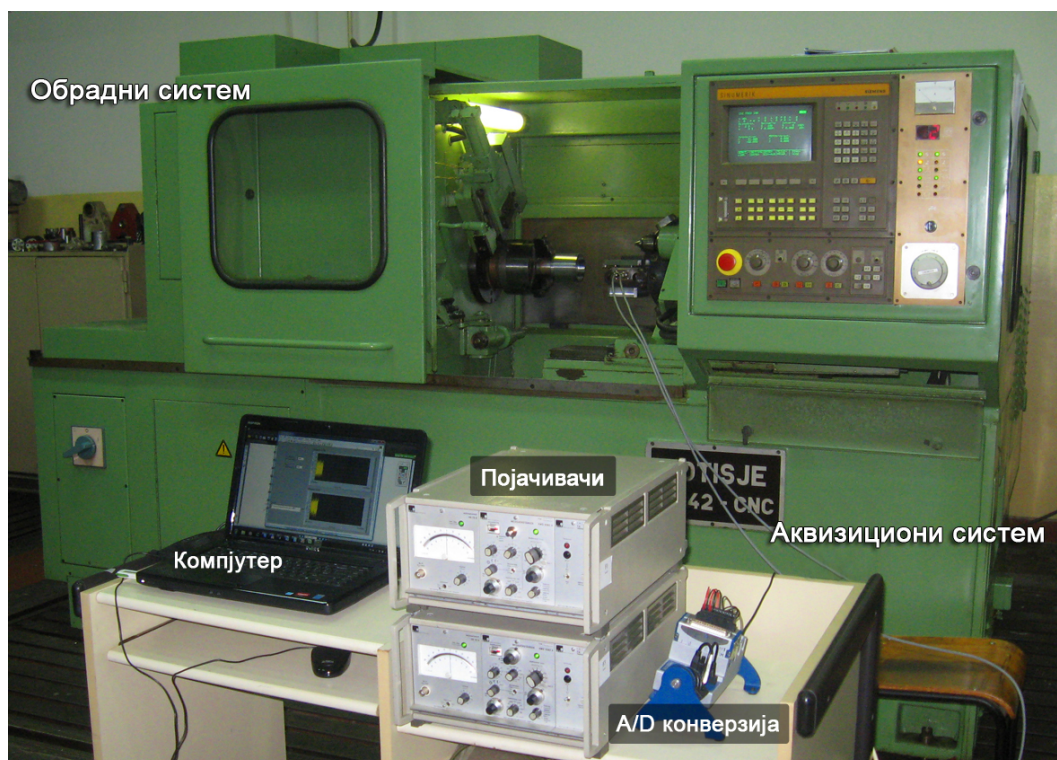
Слика 5.2. Обрадни и аквизициони систем
