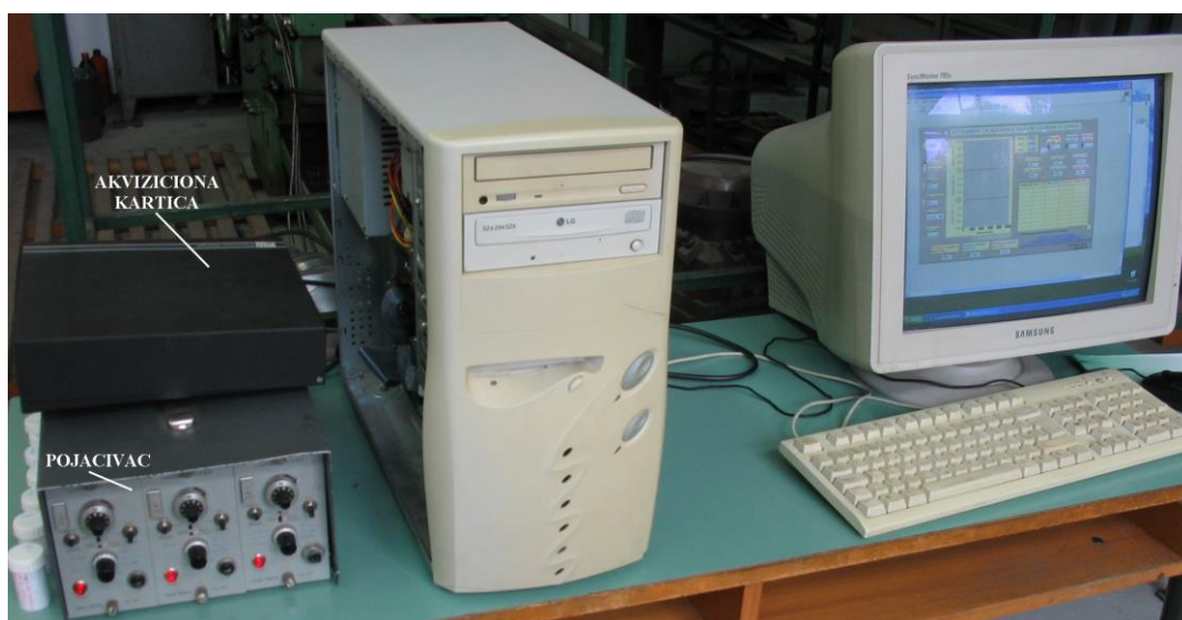
Slika 78. Prikaz dela opreme za merenje otpora rezanja pri struganju: kapacitivni pojačivač, akviziviona kartica i program Labvju
