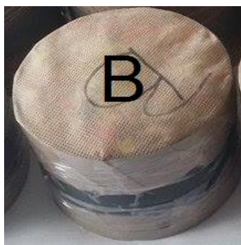
Слика 45. Изглед готовог узорка (B) за мерење звучне апсорпције
