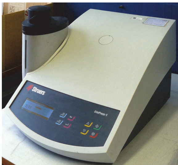
Слика 5.9. Преса за узорке, STRUERS CitoPress-1
