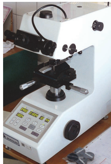
Слика 5.13. Уређај за мерење тврдоће Buehler IndentaMet
