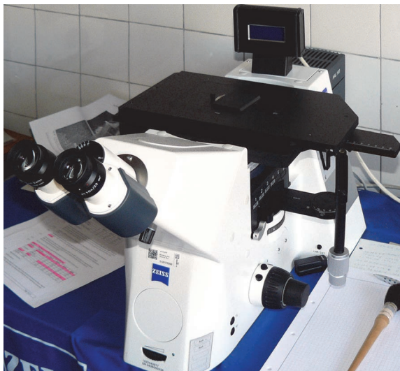
Слика 5.12. Металушки микроскоп Zeiss AxioObserver 5
