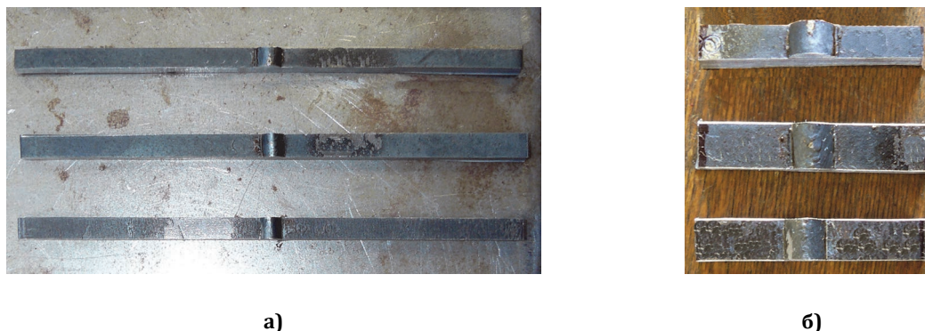
Слика 5.17. Епрувете за металографију: а) након обраде на тракастој тестери BOMAR ergonomic; б) након обраде на кружној тестери STRUERS Labotom
