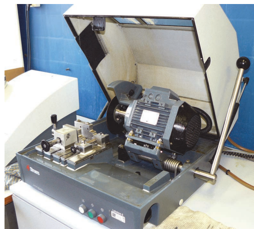
Слика 5.8. Кружна тестера STRUERS Labotom-3
