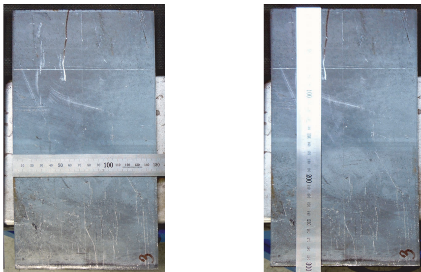
Слика 5.14. Димензије припремљених узорака од челика P355GH
