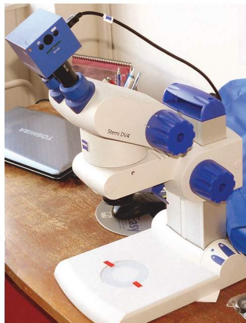
Слика 5.11. Стерео микроскоп STEMI DV4 са камером AxioCam ERc 5s
