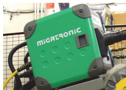
Слика 5.6. Уређај за додавање жице
