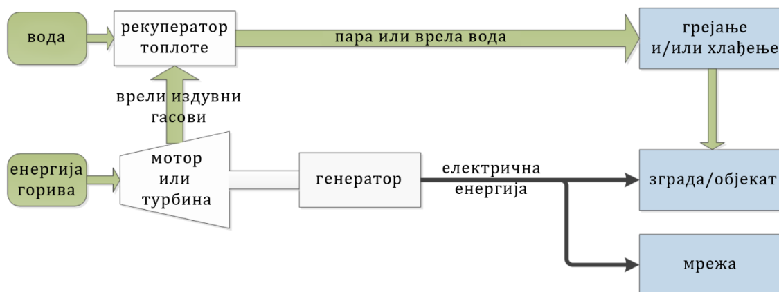
Слика 3.1 Приказ постројења са вршним (горњим) циклусом, [82]
