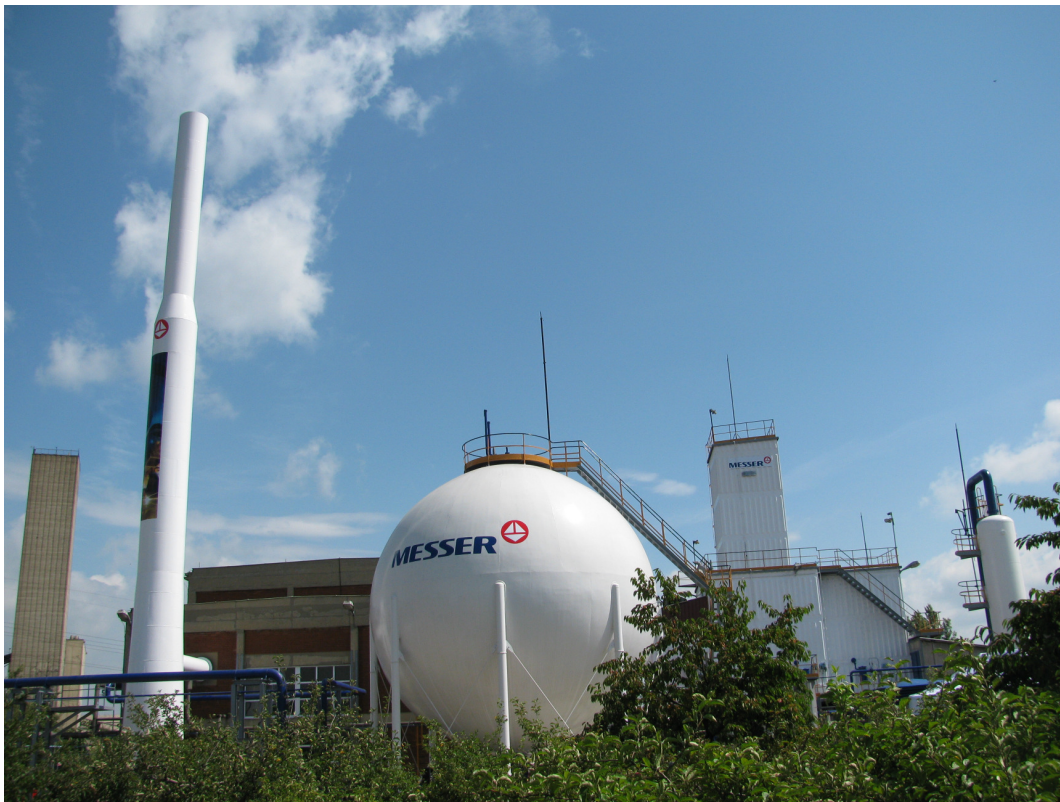
Слика 2.4: Криогено постројење за добијање кисеоника и азота у „Фабрици Техничких Гасова“ у Бору
