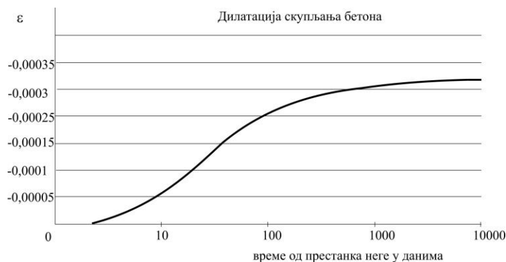
Слика 2.4 Промене дилатације скупљања бетона током времена – време неге 3 дана
