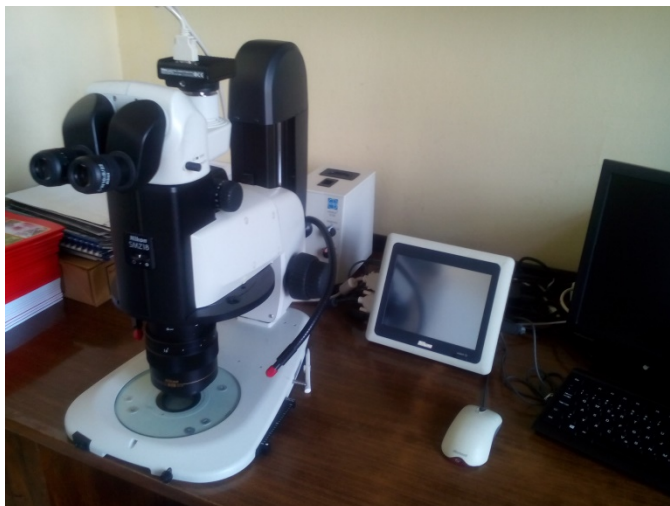
Slika 4.5. Stereomikroskop korišćen za posmatranje rehidriranog tropa paradajza
