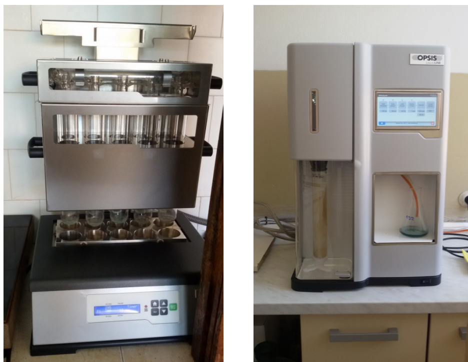
Slika 28. KjelROC digestor (levo) i KjelROC auto destilaciona jedinica (OPSIS Liquid LINE, Švedska, desno)
