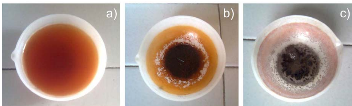
Slika 2.3.3. Koraci u metodi kalupa: a) rastvor škroba i soli u vodi, b) čvrsti kompozit dobijen sušenjem rastvora, c) prah dobijen nakon spaljivanja i žarenja
