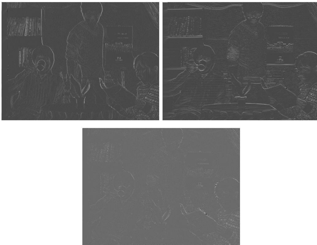
Слика 4.1.5. Подопсези првог нивоа декомпозиције фрејма из видео секвенце Newspaper морфолшким таласићем minLift садрже ивице по правцима: вертикалне, хоризонталне, угаоне.
