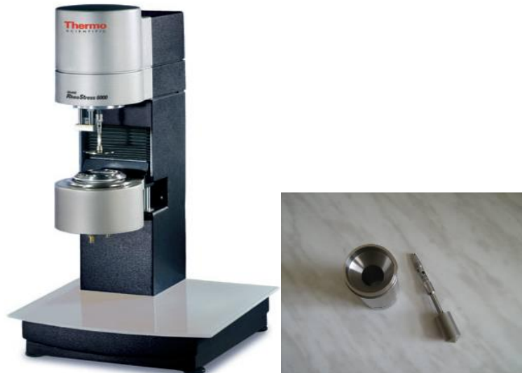
Slika 13 RheoStress 600, Haake i pribor koji se koristi u reološkoj analizi masnih masa
