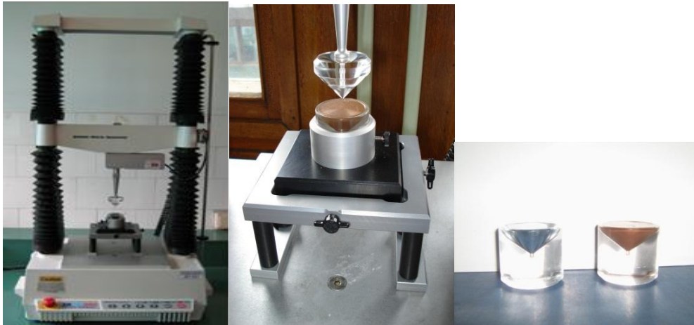
Slika 11 Teksturometar TE32 i pribor koji se koristi pri teksturalnoj analizi masnih masa
