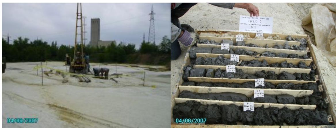
Slika 12. Bušenje i uzorkovanje flotacijske jalovine
