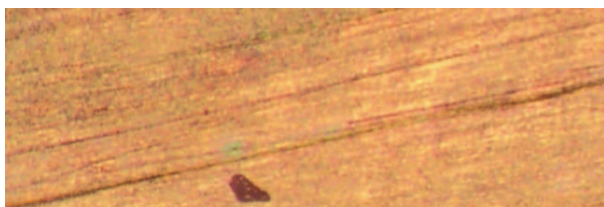
Slika 6. Površina bakarne elektrode posmatrana pod mikroskopom sa uvećanjem 200 puta nakon anodne polarizacije do 0,500 V(ZKE) u 0,5 mol dm -3 Na 2 SO 4 pH = 9
