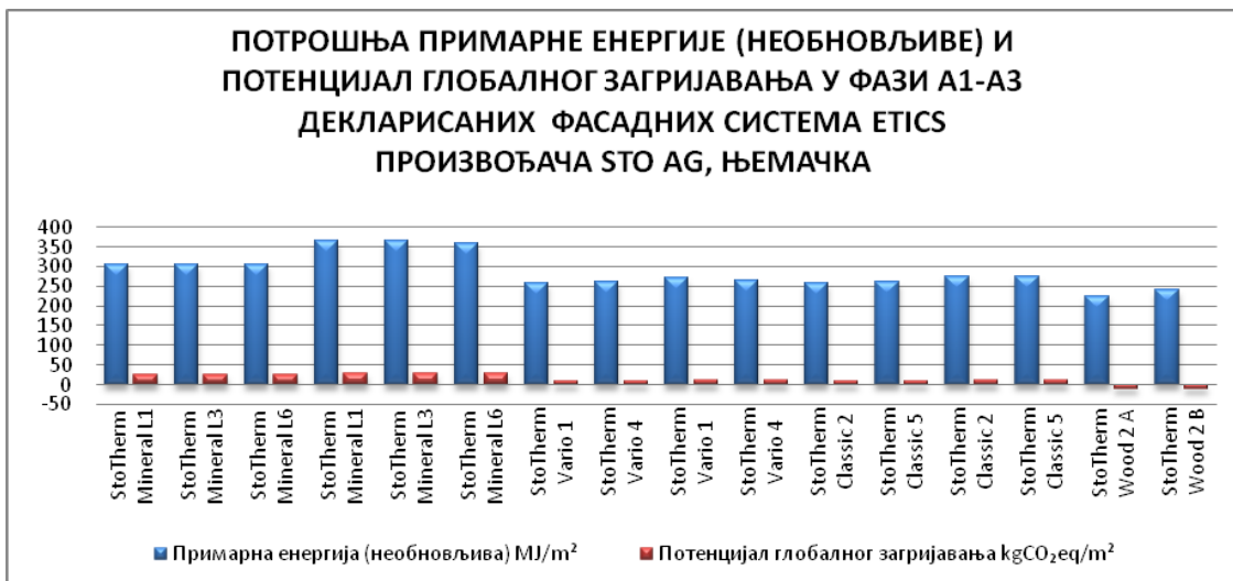
Графикон 61. Упоредни приказ потрошње примарне енергије и потенцијала глобалног загријавања при производњи цјеловитих контактних фасадних система (ETICS) STO AG-а из Њемачке према декларацијама EPD-а IBU института из Њемачке
