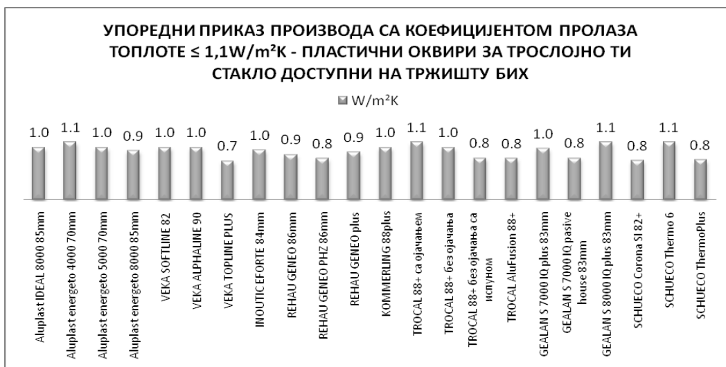
Графикон 77. Упоредни приказ пластичних оквира доступних на тржишту Босне и Херцеговине са U_f -коефицијентом \leq 1,1\text{W/m}^2\text{K}
