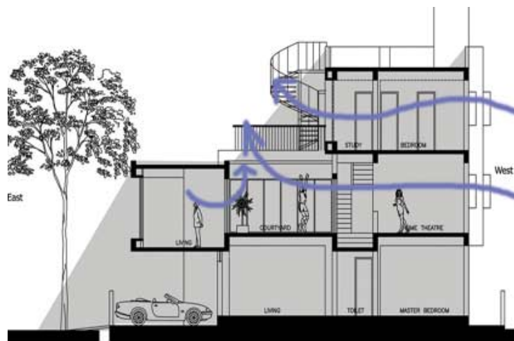
Слика А16. Графички приказ природног провјетравања зграде (доступно 20.03.2013. године на сајту http://www.gradimo.hr/clanak/prirodna-ventilacija/15598 )
