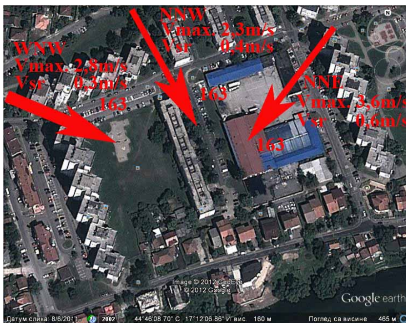
Слика 68. Прорачунати параметри максималне и средње брзине вјетра у стамбеном блоку дијела насеља Борик према доминантим вјетровима за подручје града Бањалука
