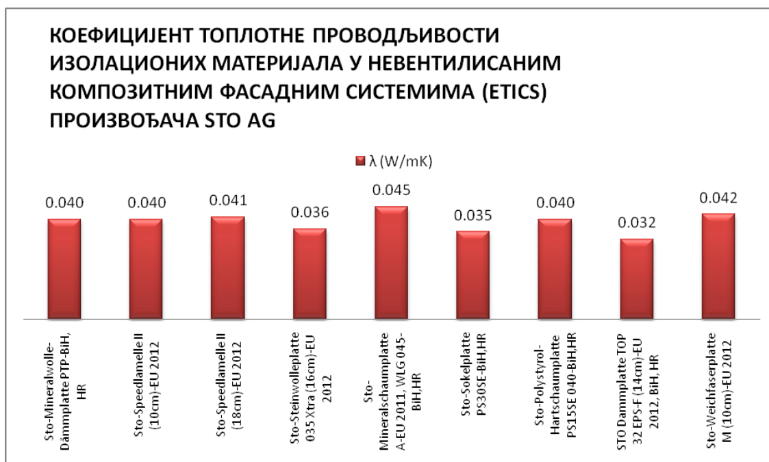
Графикон 58. Вриједности коефицијената топлотне проводљивости појединих изолационих материјала који су декларисани у Европској унији у цјеловитим фасадним системима произвођача StoAG ( http://bau-umwelt.de/hp474/Umwelt-Produktdeklarationen-EPD.htm )
