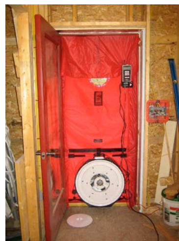
Слика А10. Blower-Door тест – графички приказ, лијево из литературе (Hegger M., Fuchs M., Stark T., Zeumer M., Energy Manual: sustainable architecture , 2008., стр. 94) и десно приказ у пракси Њемачке у новоградњи (доступно 30.10.2012. на сајту http://www.schwarz-thermografie.de/inhalte/blower.htm )
