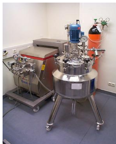
Slika 2.8. Homogenizatori srednjeg i velikog kapaciteta: (a) Micron LAB 60 (APV Deutschland GmbH, Unna, Nemačka); (b) APV Gaulin 5.5 (APV Deutschland GmbH, Unna, Nemačka) (preuzeto iz Shegokar i sar., 2011)
