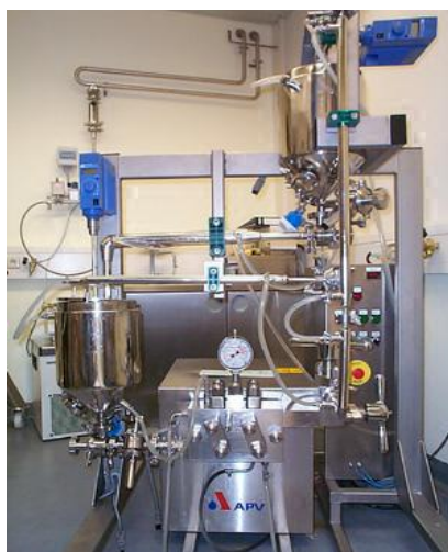
Slika 2.8. Homogenizatori srednjeg i velikog kapaciteta: (a) Micron LAB 60 (APV Deutschland GmbH, Unna, Nemačka); (b) APV Gaulin 5.5 (APV Deutschland GmbH, Unna, Nemačka) (preuzeto iz Shegokar i sar., 2011)
