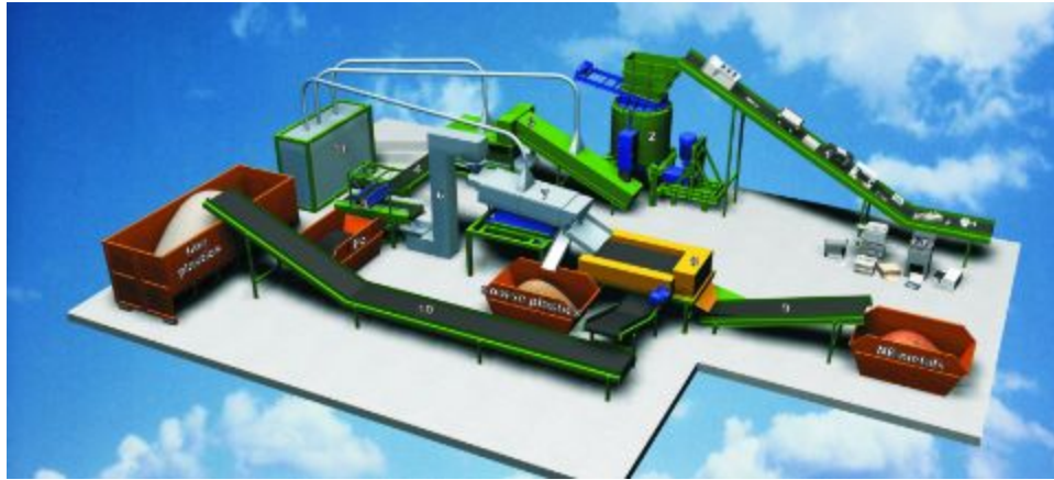
Слика 10. Шематски приказ линије за рециклажу ЕЕ–отпада [90]
