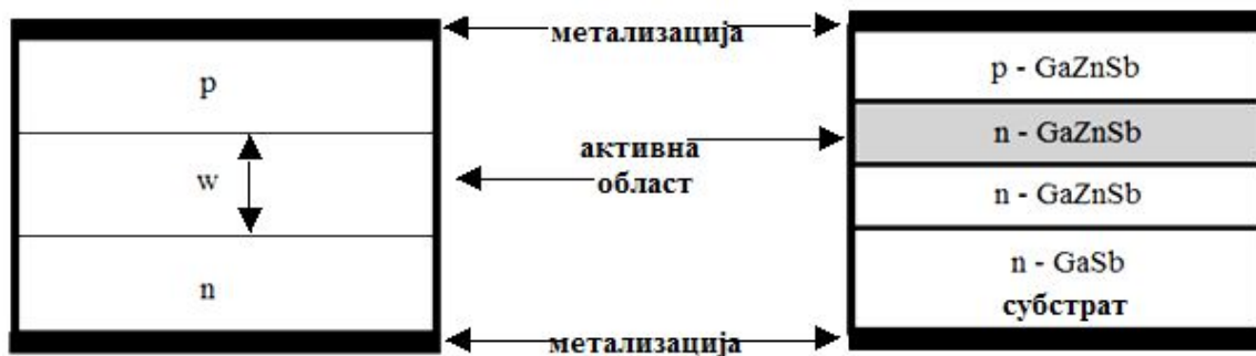
Слика 66. Структурни приказ ласерске диоде: а) као обичног pn споја и (б) као хетероструктуре
